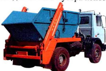
Рис. 4.16. Бункеровоз МКС-3501 на шасси МАЗ-5551А2
