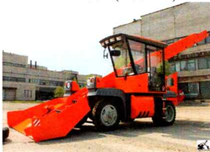
Рис. 6.20. Лаповый снегопогрузчик КО-206.
