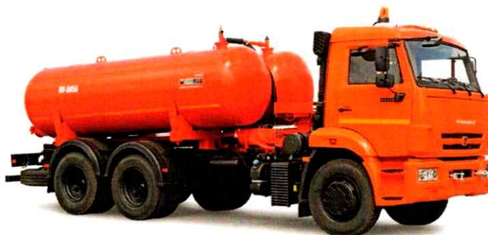
Рис. 5.1. Вакуумная машина КО-505А на шасси КамАЗ-65115-71
